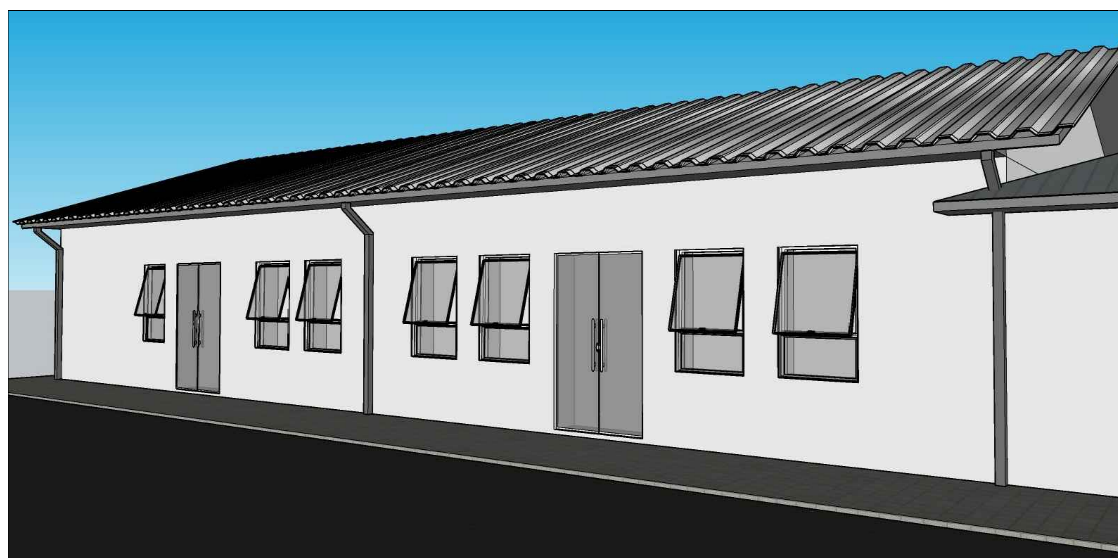
Vista lateral perspectiva 3D Cobertura telha sanduiche
